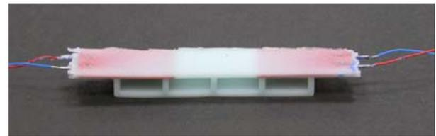
Fig. 14. Piezofilm contact sensor.
